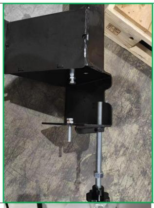
35.LACE THE L BRACKET ON THE BACK OF THE MACHINE USING THE LOCKING PLATE FROM THE INSIDE
