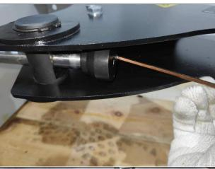
16.CONNECT THE SPRING TO THE CABINET AND TO THE BEAD BREAKER ARM
